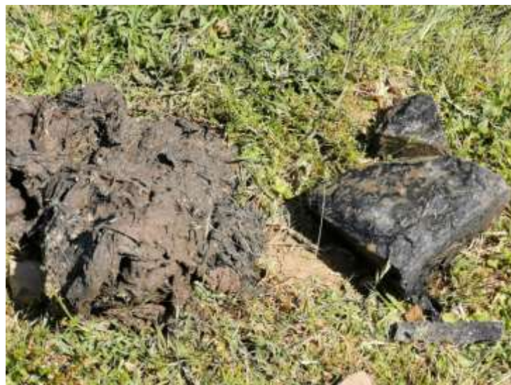
A gauche de la photo tas de lingettes extraites de la canalisation principale.
